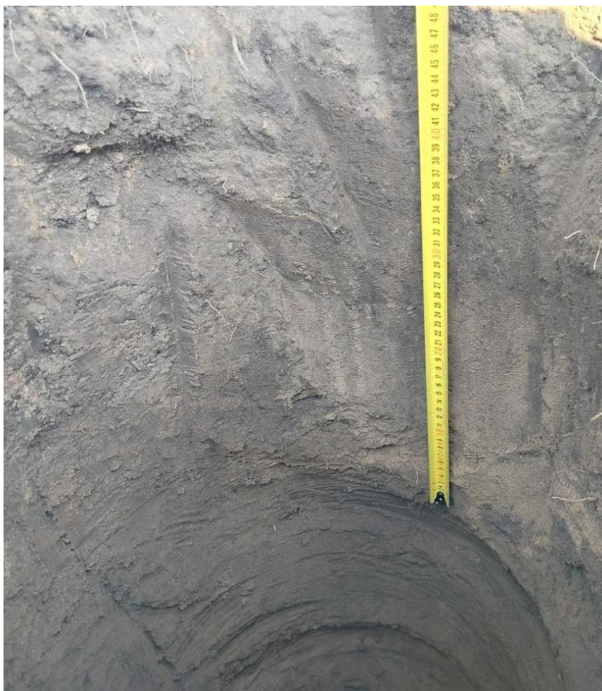
Рисунок 9. Лицевая стенка почвенного разреза, заложенного на территории (почвенный профиль исследуемого участка)
