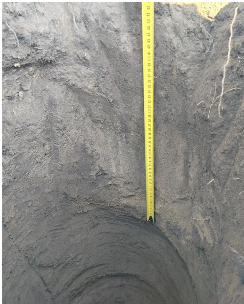
Рис. 5 Лицевая стенка почвенного разреза, заложенного на территории (почвенный профиль исследуемого участка)
